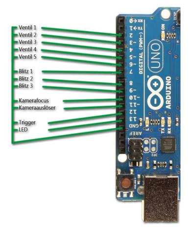
Die LED ist auch kein muss, wer die nicht nutzen will lässt sie einfach weg. Ansonsten genauso wie den Taster anschließen, ohne Vorwiderstand direkt an Pin 13 und GND.
