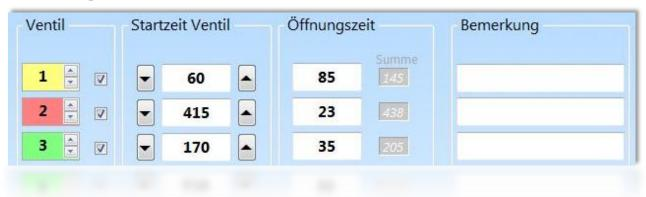
Die Ventile, bzw. die einzelnen auszulösenden Tropfen werden auf folgende Weise gesteuert. Jede Zeile im oben dargestellten Bild, steht für einen Tropfen der ausgelöst werden soll. Es sind also bis zu 10 einzelne unabhängige Tropfen pro Vorgang möglich.
